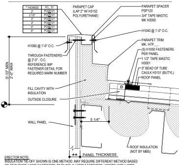
ON SEQUENCE.H1020 FASTENERS (PURLINS) & H1070 FASTENERS (JOISTS) WITH H2200 INSULATION WASHERS HAVE BEEN SUPPLIED 12" O.C. FOR INSULATION ATTACHMENT
